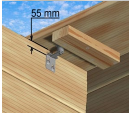
Abbildung 69 – Montage des Schließmechanismus
