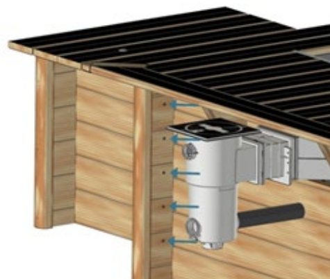
Abbildung 65 – Befestigung des Motorschachts am Pool
