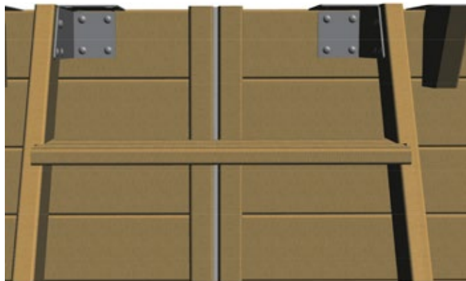
Abbildung 18 – Anbringen der Außenterrasse am Becken
