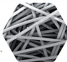
Das Filtermaterial des NanoFiber-Filters nimmt keinen Schmutz auf, so dass die Wasserqualität verbessert wird: nach dem Spülen wird praktisch die gleiche Durchflussmenge erzielt.
