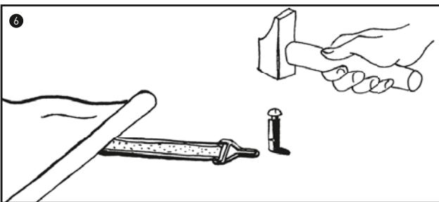
**6 Mettre en place les pitons inox avec douille, à l'aide d'un marteau.**
