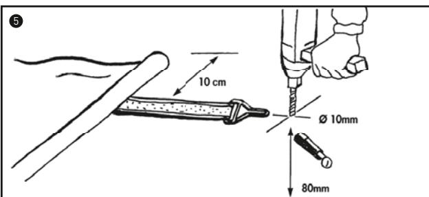
**5 IMPORTANT :** pour les fixations, commencer par le côté du rangement (stockage). Positionner, en les glissant, les 2 sangles d'extrême, à 10 cm du bout du profil aluminium. Répartir à distances égales les autres sangles le long du profil. Les pitons à douilles doivent impérativement être fixés sur un dallage solide. Percer en Ø 10 mm avec une profondeur de 80 mm en face de chaque sangle pour la mise en place des pitons escamotables inox.
