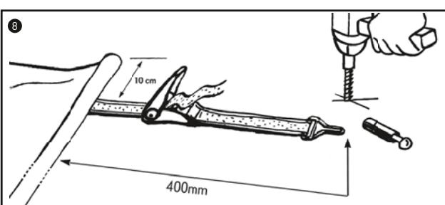
**9 Modèles EVOLUTION et STARLIGHT non équipés de l'option WINDSAFE (système anti-soulèvement sur les longueurs) :** Pour les fixations (tendeurs cabiclics avec pitons) sur longueurs, percer avec une légère inclinaison extérieure (afin qu'un piton ne puisse glisser et sortir du trou) en diamètre 7 mm avec une profondeur de 80 mm. Placer les tendeurs cabiclics dans les œillets en réalisant une boucle suivant schéma.
