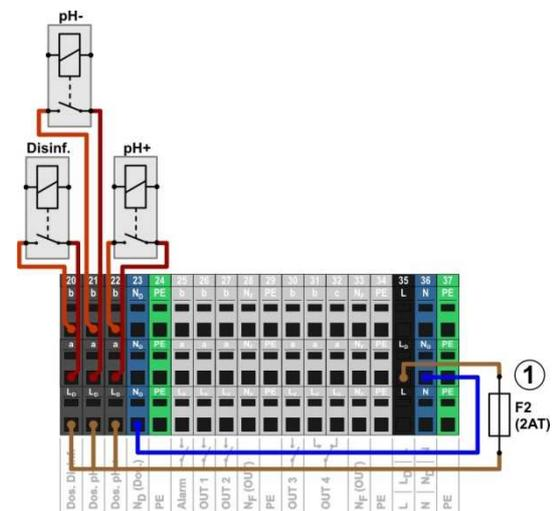
1 Sicherung 2AT für die 230V~ Phase L<sub>D</sub> zur Versorgung der Dosierausgänge
