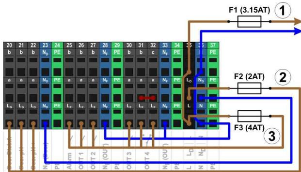
Die Versorgung für das PoolManager® Gerät sowie für das Alarm-Relais und die Zusatz-Funktionen teilen sich einen gemeinsamen Netzeingang (L/N). Die Phase L für den PoolManager® wird vom Eingang über die Sicherung F1 geführt. Die Phase L<sub>F</sub> für das Alarm-Relais und die Zusatz-Funktionen wird vom Eingang über die Sicherung F3 geführt. Die Nullleiter N und N<sub>F</sub> sind intern miteinander verbunden.
