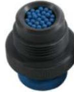
Bitte stellen Sie sicher, dass die Gold-Fläche mit einer Lage von den blauen Glasperlen bedeckt ist. Nur so wird die gesamte Fläche der Elektrode einwandfrei gereinigt.
