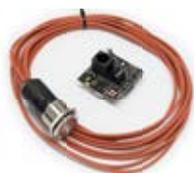
Der HOT-Taster löst eine sofortige, intensive Aufheizphase des Ofens aus, um kurz darauf einen kraftvollen Ausguss zu ermöglichen. Auch der Betrieb in Zeitintervallen ist möglich.
