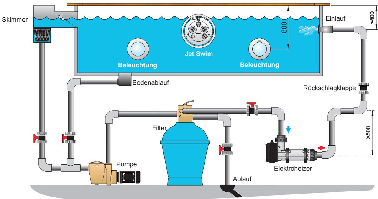
1. Nach Abschluss der Rohrinstallation ist der Elektroheizer gemäss Schaltplan elektrisch anzuschliessen.
