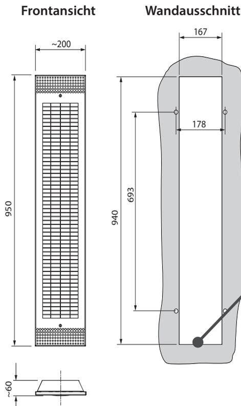
**⚠ ACHTUNG!** Ausreichende Belüftung hinter und über dem Strahler muss gewährleistet werden. Der Raum über dem Strahler darf nicht blockiert sein, damit die warme Luft frei aufsteigen kann.
