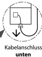
**⚠** Achten Sie darauf, den IR-Strahler so zu installieren, dass sich der Kabelanschluss auf der Unterseite befindet.
