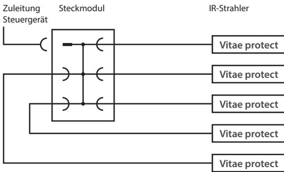
Bei 750 W Strahlern max. 4 Stück (3500W) bei 16 A Zuleitung
