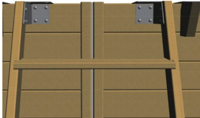
Abbildung 17 – Anbringen der Außentreppe am Becken
